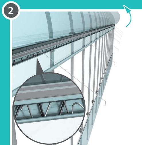
2 残した余尺フィルムを上を持ち上げ、フィルム止にノキボーを1mピッチに取り付けて完成。
