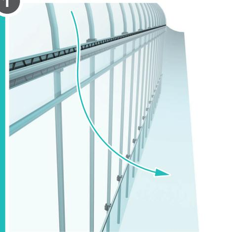
1 屋根面のフィルムを余尺を残して留めます。
