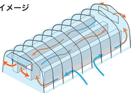
サイドから空気を取り入れ、妻面から外に空気を吐き出すことで自然換気が行えます。循環扇と組み合わせると（強制換気）より効果的です。
